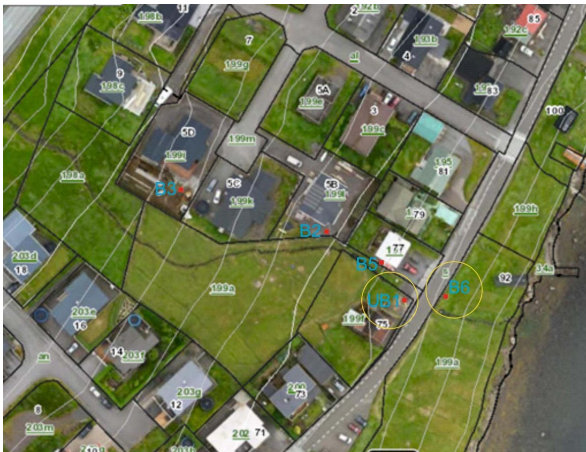
Mynd 1. Staðseting av boringunum á Lygnnesi í Kollafirði, sum renna við vatni. Kanningar eru gjørdar av vatninum, sum rennur úr UB1 og B6 (sí boringarnar í gulu rundingunum).
